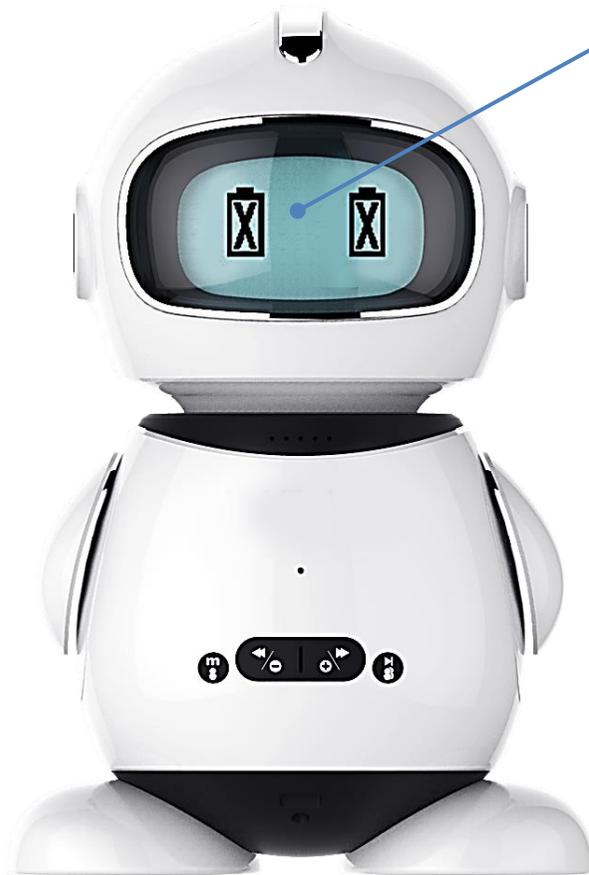
L'icona "Batteria Scarica" apparirà quando la batteria è al 20%
